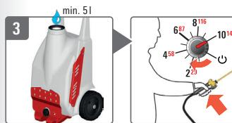
**Max. Druck einstellen, sprühen bis keine Flüssigkeit mehr austritt**
