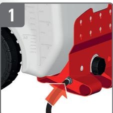
Schlauch an Anschluss schrauben
